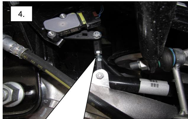
Fahrzeug gegen wegrollen sichern und Motor starten. Eibach Regelstange über die Einstellschraube soweit zusammendrehen (1 Umdrehung ca. 8mm) bis der Höhenstand lt. Teilegutachten Seite 11, Punkt IV.6 erreicht wird. Beide Seiten der Eibach Regelstange kontern.
